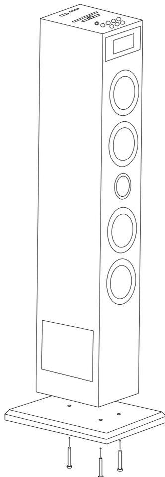
3. Utilisez un tournevis pour serrer les trois vis sous le pied. Ne serrez pas exagérément, pour éviter d'endommager le pied et la station d'accueil.
