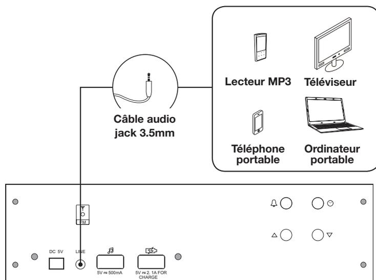
1. Connectez la première extrémité d'un câble jack 3,5 mm (non fourni) à l'entrée auxiliaire **LINE** située à l'arrière de l'appareil.
