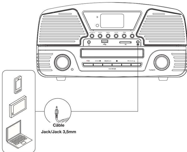
1. Branchez l'extrémité d'un câble Jack 3,5mm / Jack 3,5mm (non fourni) dans la prise AUX située sur la face avant de l'appareil.
