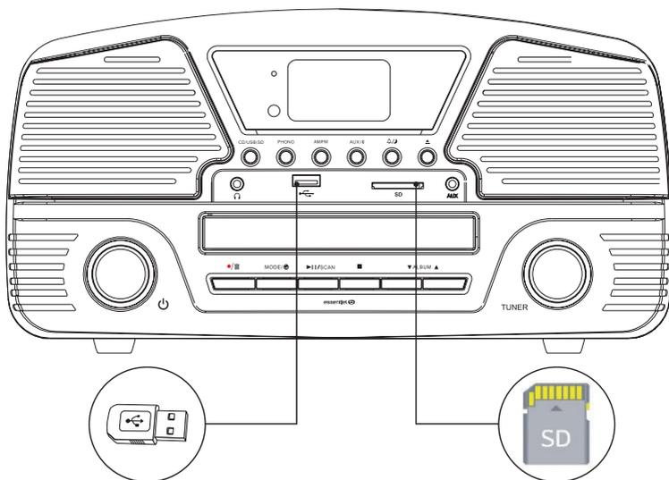
**6** Le port USB permet également de recharger vos périphériques USB lorsque la micro-chaîne est allumée, en délivrant une tension de 5V/500mA, quelque soit la source sélectionnée.
