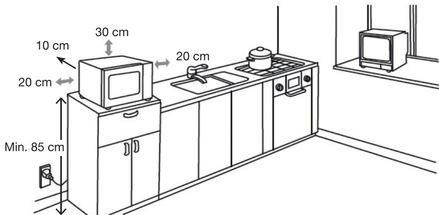
Assurez-vous que rien n'obstrue les orifices de ventilation sur les côtés, le dessus et à l'arrière de l'appareil.
