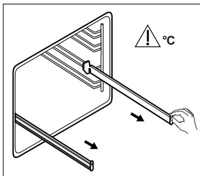
2. Placez la grille métallique sur les rails télescopiques et poussez-les dans l'appareil.
