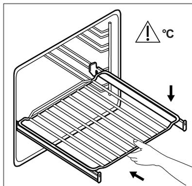
Assurez-vous d'avoir poussé complètement les rails télescopiques dans l'appareil avant de fermer la porte du four.
