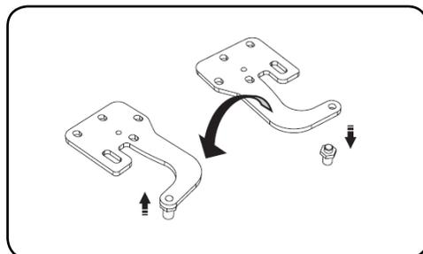
11. Placez le cache-vis (A) de la charnière supérieure (C) du côté gauche, fixez-le avec les vis (B) et installez le cache-trous (D) du côté droit.
