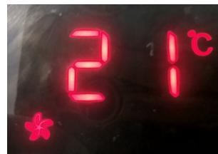
**Lüftung:** Das Gerät heizt nicht und funktioniert im Raumluft-Lüftungsmodus. Das Symbol und die ausgewählte Temperatur werden auf dem Bildschirm angezeigt.
