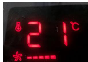
**Mittlere Intensität:** das Gerät funktioniert mit mittlerer Leistung und die Symbole und werden auf dem Bildschirm angezeigt. Die Intensitätsleiste leuchtet zur Hälfte. Auf dem Bildschirm wird die ausgewählte Temperatur angezeigt.
