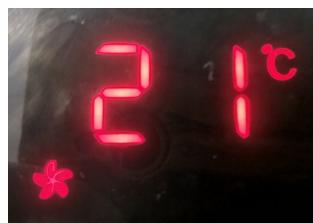
**Ventilación:** el electrodoméstico no calienta y ventila el aire ambiente. El símbolo
