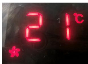
**Ventilation** : l'appareil ne chauffe pas et ventile l'air ambiant. Le symbole
