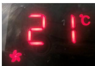
**Ventilatie:** het apparaat verwarmt niet en ventileert de omgevingslucht. Het symbool
