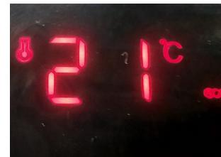
**Éco** : l'appareil fonctionne à puissance de chauffe économique et ajuste automatiquement la température pour que celle-ci reste constante dans la pièce. Le symbole
