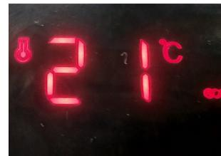
**Eco:** el electrodoméstico funciona con una potencia de calefacción económica y ajusta automáticamente la temperatura para mantenerla constante en la habitación. El símbolo
