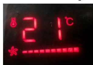
**Hohe Intensität:** das Gerät funktioniert mit voller Leistung und die Symbole und werden auf dem Bildschirm angezeigt. Die Intensitätsleiste leuchtet vollständig. Auf dem Bildschirm wird die ausgewählte Temperatur angezeigt.
