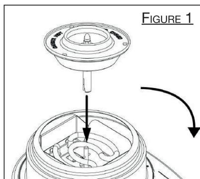
4. Placez la couronne inférieure blanche (2) sur le bloc moteur (6) et faites-la tourner dans le sens inverse des aiguilles d'une montre afin que les pattes se bloquent sous les moulures de fixation situées sur le bloc moteur. Pour vérifier que la couronne (2) est bien fixée, vous devez pouvoir soulever l'appareil en le tenant par la couronne sans que le bloc moteur ne se détache.
