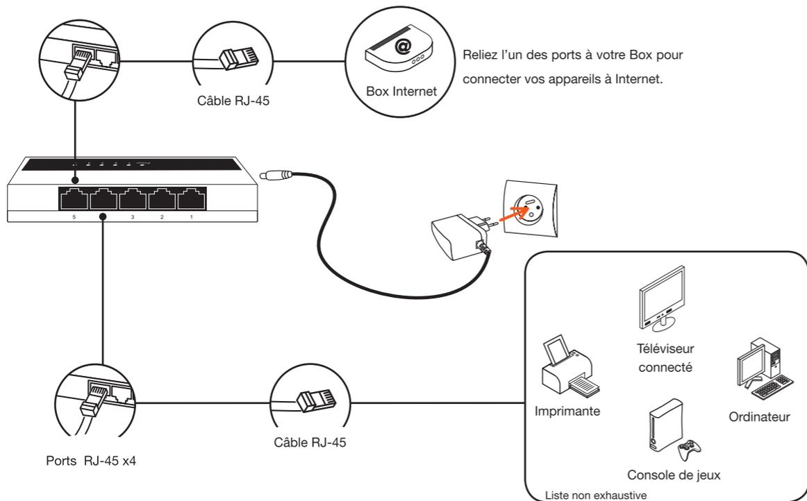
1. Connectez la fiche du câble d'alimentation dans la prise DC-IN située sur le côté de l'appareil.
