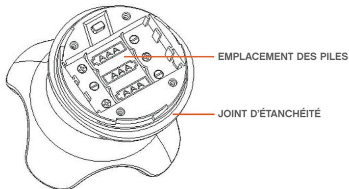
1. Tournez le couvercle dans le sens inverse des aiguilles d'une montre vers la direction « OPEN ».
