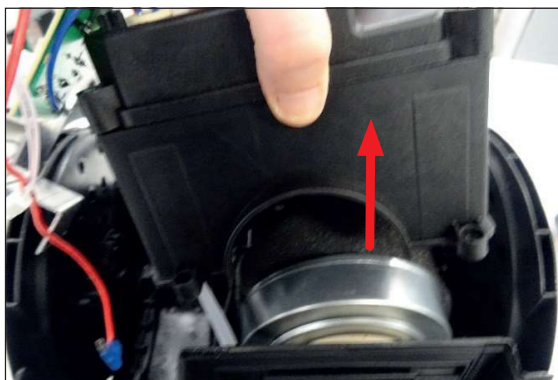
13 Dépose du moteur : soulever le carter moteur. Removing the motor: lift up the motor casing
