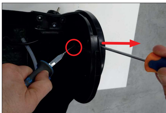
15 Écarter la roue à l'aide d'un tournevis plat et appuyer sur les ergots en plastique qui maintiennent la roue. Pull apart the wheel using a flat-head screwdriver and press the plastic lugs holding the wheel in place.
