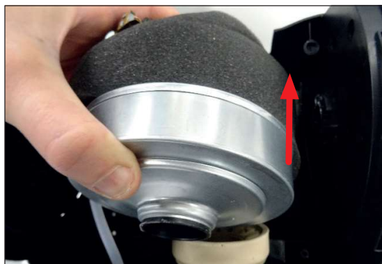
14 Soulever le moteur de son emplacement. Lift the motor out from its space
