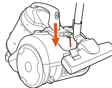
Une patte est prévue à l'arrière de l'appareil pour fixer le tube télescopique et la brosse 2 positions.
