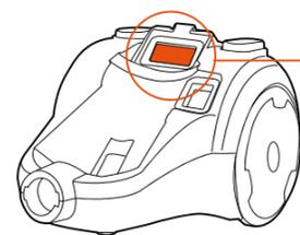
**Filtre mousse** : retirez le filtre mousse situé sous la cuve à poussière.
