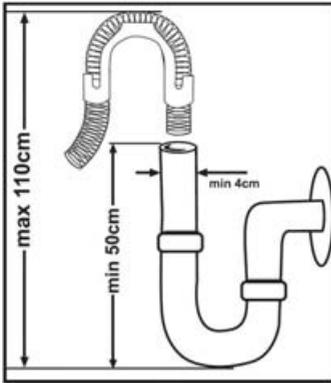
On peut raccorder le tuyau de vidange, soit directement à une vidange fixe, soit à un raccord spécial sous l'évier. Au moyen d'un tuyau coudé spécial (si disponible), vous pouvez vidanger le lave-vaisselle directement dans l'évier en accrochant le tuyau coudé au bord de l'évier. Ce raccordement doit se trouver à au moins 50 cm et au plus 110 cm du niveau du sol.
