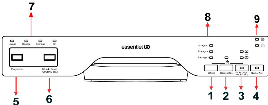
Appuyez sur le bouton Marche/Arrêt (4) pour mettre l'appareil sous tension. Le voyant Marche/Arrêt reste allumé tant que l'appareil est en sous tension. Appuyez successivement sur le bouton Programme (5) jusqu'au programme souhaité. Le voyant correspondant au programme sélectionné s'allume.
