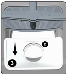
Pour extraire et nettoyer le groupe filtrant, tournez-le dans le sens inverse des aiguilles d'une montre et retirez-le en le soulevant. **1**
