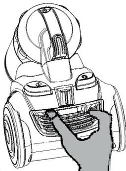
2. Retirez le filtre de sortie d'air de type EPA 12 à l'aide des languettes latérales, puis secouez-le au-dessus d'une poubelle :
