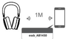
Le mode appairage dure environ 5 minutes. Si aucun appareil n'est appairé dans ce laps de temps, le casque passe en mode veille automatiquement.
