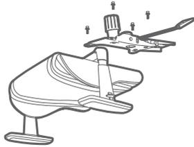
2. Fixez le mécanisme à l'aide des quatre longues vis, des rondelles de blocage puis des rondelles plates.
