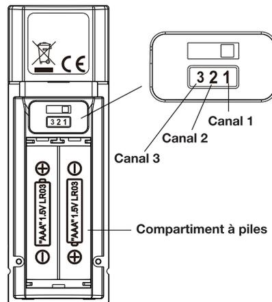
Le canal 1 est le canal de diffusion utilisé par défaut par votre radio-réveil. Sélectionnez le canal 1 sur la sonde extérieure afin d'assurer la liaison entre les deux éléments.
