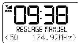
Tournez la molette de réglage pour commuter entre les plages de fréquences 5A à 13 F. Appuyez sur la molette de réglage pour ouvrir la plage sélectionnée et afficher la force du signal. Vous pouvez augmenter la qualité de réception en alignant l'antenne.
