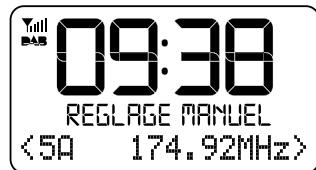
Gire la rueda de ajuste para cambiar entre rangos de frecuencias, de 5A a 13F. Pulse la rueda de ajuste para abrir el rango seleccionado y ver la intensidad de la señal. Puede aumentar la calidad de recepción moviendo la antena. Durante la búsqueda manual no suena ninguna emisora. Las emisoras encontradas en el rango de frecuencias se añaden automáticamente a la lista de emisoras memorizadas. Para acceder a ellas, salga de la búsqueda manual y vaya a la lista de emisoras memorizadas.
