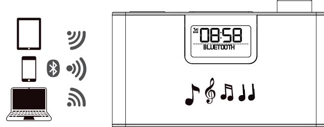
1. Pulse varias veces la tecla hasta seleccionar la fuente BLUETOOTH. Suena un pitido y la palabra BLUETOOTH parpadea rápidamente en la pantalla. La radio está lista para emparejarse.
