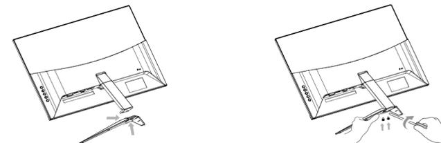
3. Insérez les 2 vis et serrez-les à l'aide d'un tournevis.
