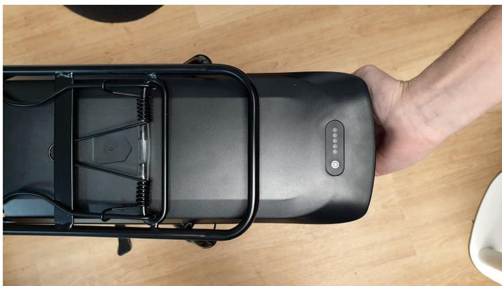
Pour verrouiller, insérez la clé dans la serrure et faites un demi-tour dans le sens horaire (batterie et porte-bagage verrouillés). Vous pouvez déverrouiller en faisant un demi-tour dans le sens antihoraire.
