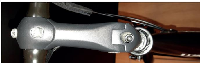
Veillez à ne pas dépasser le repère minimum d'insertion. Ce repère d'insertion ne doit jamais être visible lors de l'utilisation du vélo.
