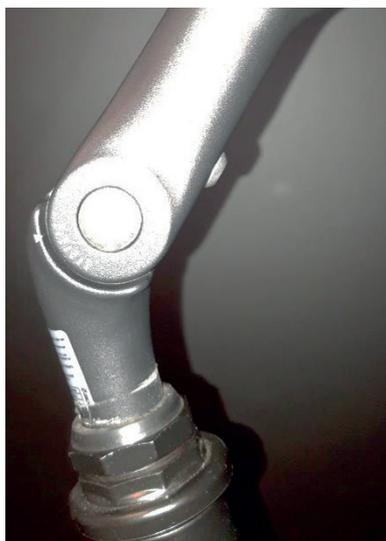
Il est souvent nécessaire ensuite d'ajuster la position du cintre sur la potence en desserrant les vis du capot de la potence, tournez le cintre à votre convenance et resserrez ces mêmes vis. Prenez garde à ce que le cintre soit correctement centré.
