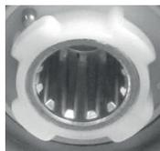
3. Pour faciliter le démontage des accessoires (grilles à viande, kit à saucisses, kit à kebbés, cônes du rapeur/trancheur), vous pouvez vous aider d'un tournevis à tête plate. Le cas échéant, glissez-le entre l'accessoire et son support (ex : entre la grille à viande et le tube d'alimentation), et poussez légèrement l'accessoire vers l'extérieur.
