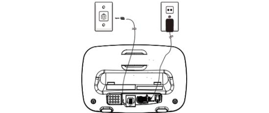
Si vous êtes connecté derrière une box ADSL, un microfiltre est nécessaire (il n’est pas fourni).
