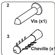
Le kit antibasculement est fourni dans le sachet des accessoires. Fixer le dispositif antibasculement (1) sur le mur à l'aide de la vis (2) et de la cheville (3), conformément aux dimensions de l'illustration et du tableau ci-dessous. Régler la hauteur du dispositif antibasculement pour l'aligner sur la rainure de la cuisinière, puis serrer la vis (2). Pousser l'appareil vers le mur en s'assurant que le dispositif antibasculement est inséré dans la rainure à l'arrière de l'appareil.
