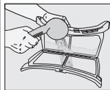
Une couche peut se former sur les mailles du filtre après avoir utilisé la machine pendant un certain temps. Lavez le filtre à l'eau chaude pour enlever la couche qui se forme sur la surface du filtre. Séchez le filtre complètement avant de le réinstaller.
