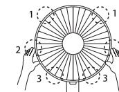
3. Montage des automatischen Verriegelungsschnappers.
