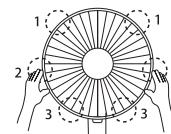
3. Montage du loquet à verrouillage automatique.
