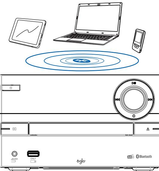
Encienda la microcadena y seleccione la fuente BT pulsando varias veces la tecla **→** de la microcadena o directamente la tecla **BT** del mando a distancia.
