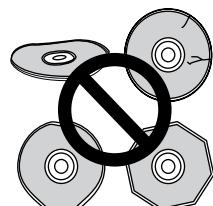
Verwenden Sie keine gespaltenen, abgeplatzten, verformten oder anderweitig beschädigten CDs, da diese den CD-Spieler beschädigen können.
