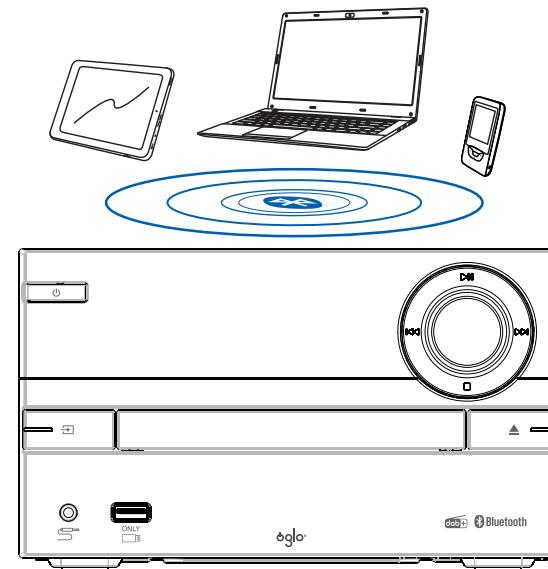
Allumez la micro-chaîne, et sélectionnez la source BT en appuyant plusieurs fois sur la touche **➡** de la micro-chaîne ou directement sur la touche **BT** de la télécommande.
