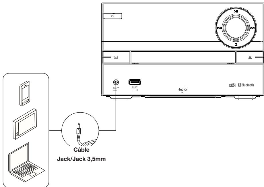
1. Branchez l'extrémité d'un câble Jack 3,5mm /Jack 3,5mm (non fourni) dans la prise située à l'avant de l'appareil.
