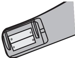
2. Positionnez les piles dans le boîtier en respectant les indications de polarité + et - indiquées.
