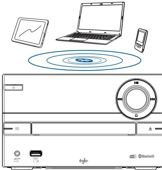
Schalten Sie die Mikro-Anlage an und wählen die BT-Quelle durch mehrfaches Drücken auf die Taste **BT** der Mikro-Anlage oder direkt mit der **BT**-Taste der Fernbedienung aus.
