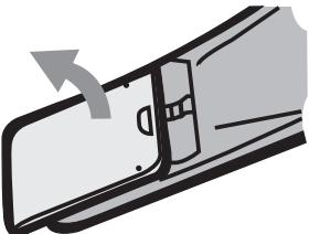
1. Den Deckel auf der Rückseite der Fernbedienung öffnen.
