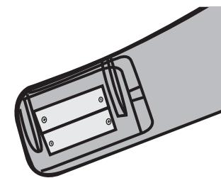
2. Coloque las pilas en el compartimento, respetando las indicaciones de polaridad + y - que se indican.
