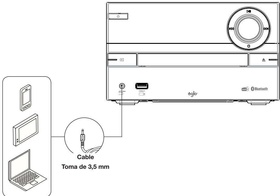
1. Conecte el extremo de un cable de toma de 3,5 mm (no incluido) en la toma situada en la parte delantera del aparato.
