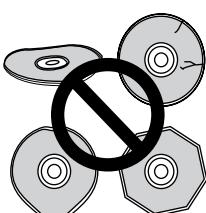
Este lector está diseñado para utilizarse únicamente con discos tradicionales, totalmente circulares. No utilizar discos que presenten otras formas.
