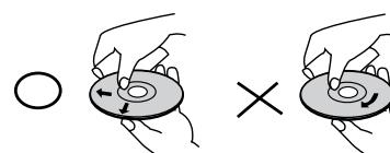
Les empreintes de doigts et la poussière sur un disque peuvent entraîner une qualité médiocre et une distorsion du son. Avant la lecture, nettoyez le disque avec un chiffon propre et sec en partant du centre vers les extrémités.
