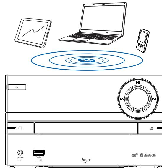
Zet de microketen aan en selecteer de BT-bron door een paar keer op de knop **→** van de afstandsbediening of op de knop **BT** van de afstandsbediening te drukken.
