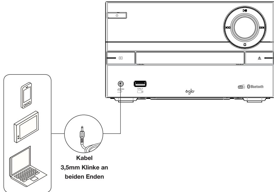
1. Stecken Sie ein Ende eines Kabels mit zwei 3,5mm Klinkensteckern (nicht im Lieferumfang enthalten) in die Buchse an der Gerätefront.
