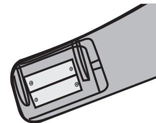
2. Plaats de batterijen in de behuizing en respecteer de aangeduide + en - polariteiten.
