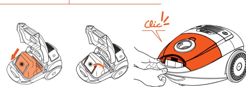
Remplacez le microfiltre pré-moteur et insérez un sac à poussière neuf dans son support. Remplacez correctement le support puis, refermez le couvercle.
