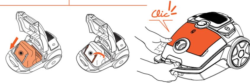
Remplacez le microfiltre pré-moteur et insérez un sac à poussière neuf dans son support.
