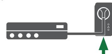
Drücken Sie 1 Sekunden lang die Taste PAIR der Powerline-Steckdose nahe der Internet-Box.
