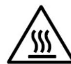
De temperatuur van de toegankelijke oppervlakken (deur en buitenoppervlak) kan hoog oplopen wanneer het toestel in werking is.
