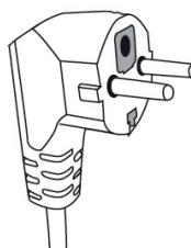
Dieser Mikrowellenofen ist mit einer geerdeten Steckdose ausgestattet. Er muss an eine ordnungsgemäß installierte und geerdete Wandsteckdose angeschlossen werden.
