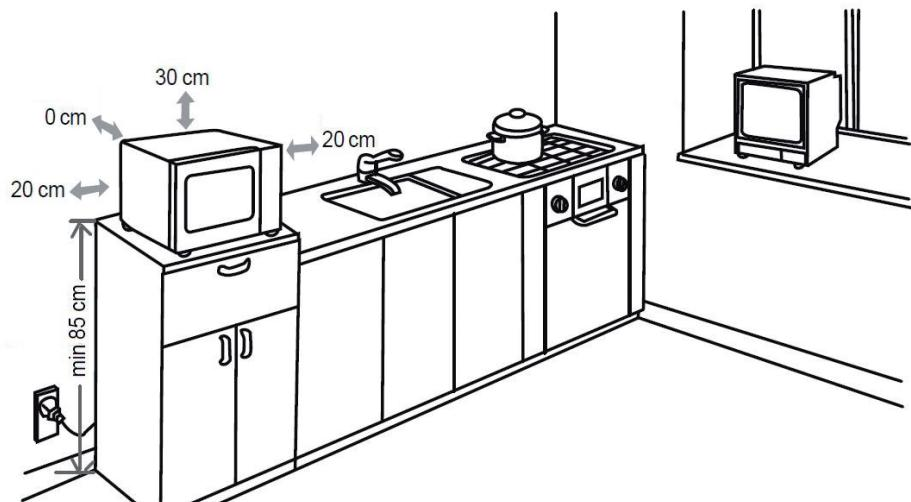
Assurez-vous que rien n'obstrue les orifices de ventilation sur les côtés, le dessus et à l'arrière de l'appareil.
