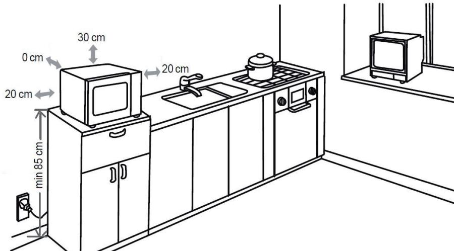
Achten Sie darauf, dass die Lüftungsöffnungen an den Seiten, der Oberseite und der Rückseite des Geräts nicht blockiert sind.
