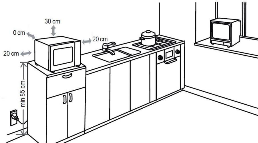
Vergewis u ervan dat de ventilatieopeningen aan de zijkanten, de bovenkant en de achterkant van het toestel niet worden afgesloten.
