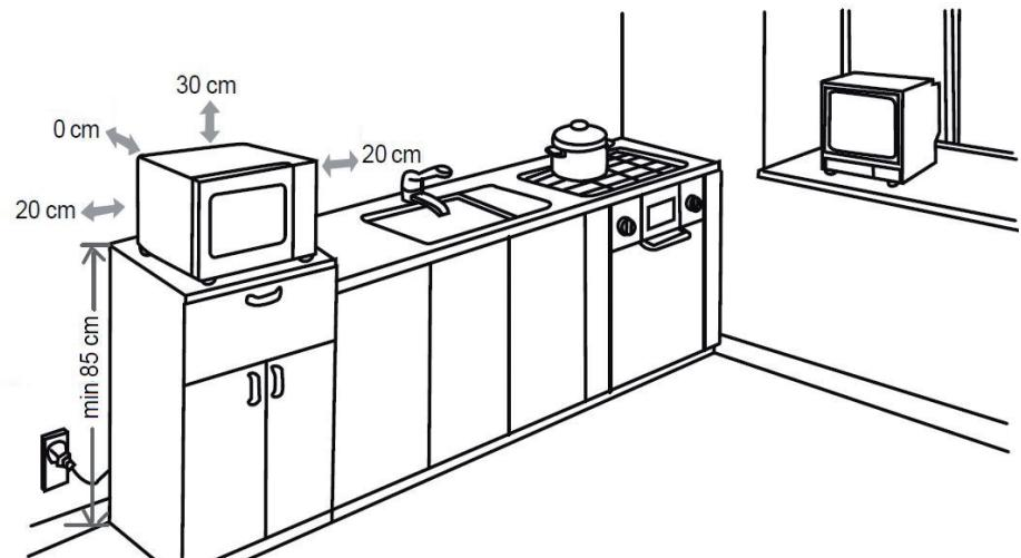
Asegúrese de que no haya nada que obstruya los orificios de ventilación en los lados, la parte superior y la parte de atrás del aparato.
