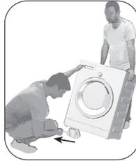
Kippen Sie die Maschine nach hinten, um die Verpackungsverstärkung zu entfernen. Entfernen Sie die Verpackungsverstärkung, indem Sie an dem Band ziehen. Führen Sie diesen Vorgang nicht alleine durch.
