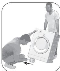
Inclinez la machine vers l'arrière pour retirer le renfort de conditionnement. Retirez le renfort de conditionnement en tirant sur le ruban. Ne réalisez pas cette opération vous-même.
