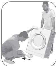
Incline el aparato hacia atrás para retirar el refuerzo del embalaje. Retire el refuerzo del embalaje tirando de la cinta. No realice esta operación usted solo.
