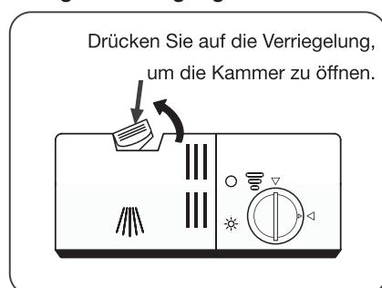
1. Drücken Sie auf die Verriegelung der Reinigungsmittelkammer, um den Deckel zu öffnen.
