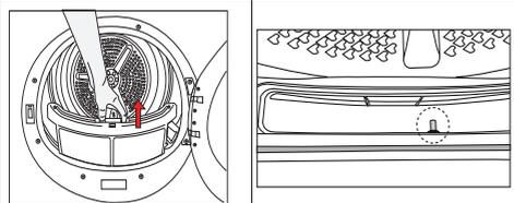
Votre machine est équipée de capteurs d'humidité qui détectent si le linge est sec ou non. Pour nettoyer le capteur :
