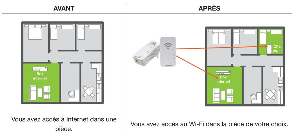
**ATTENTION :** si vous possédez la prise CPL WI-FI solo, celle-ci ne permet pas de créer un réseau. **Deux prises CPL au minimum** sont nécessaires pour créer un réseau haut débit. **La prise CPL WI-FI solo vous permet uniquement de transformer un réseau filaire existant en réseau sans fil.**
