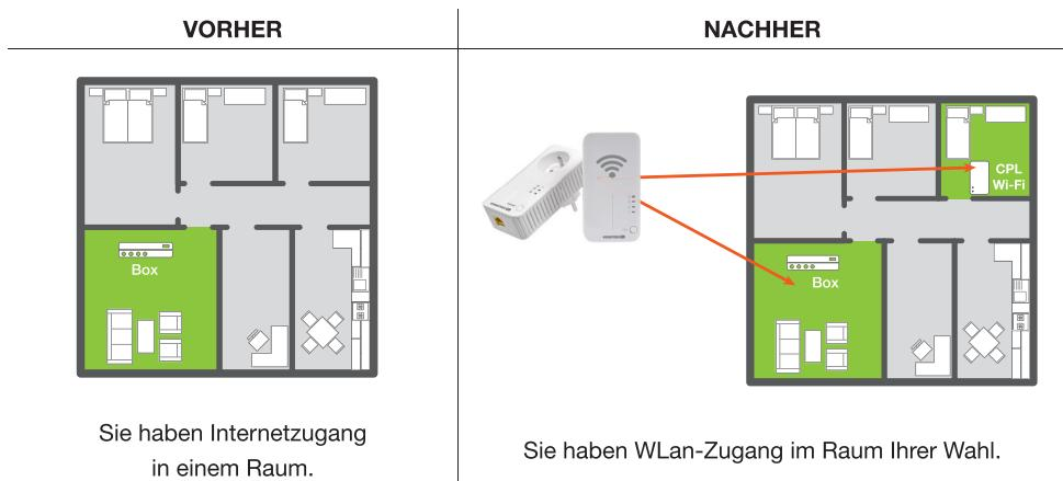
**ACHTUNG:** Mit dem WLAN Powerline-Adapter Solo allein können Sie kein Netzwerk herstellen. **Es sind mindestens zwei Powerline-Adapter** notwendig, um ein Breitbandnetzwerk herzustellen. **Mit dem WLAN Powerline-Adapter Solo allein können Sie lediglich ein bestehendes drahtgebundenes Netzwerk in ein drahtloses Netzwerk verwandeln.**
