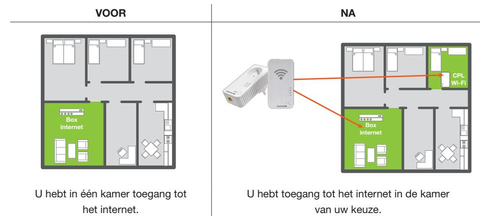
**LET OP:** als u de powerline-adapter met wifi Solo hebt, kunt u geen netwerk opzetten. **U hebt minimaal twee powerline-adapters** nodig om een breedbandnetwerk op te zetten. **De powerline-adapter met wifi Solo biedt alleen de mogelijkheid een bestaand kabelnetwerk te veranderen in een draadloos netwerk.**
