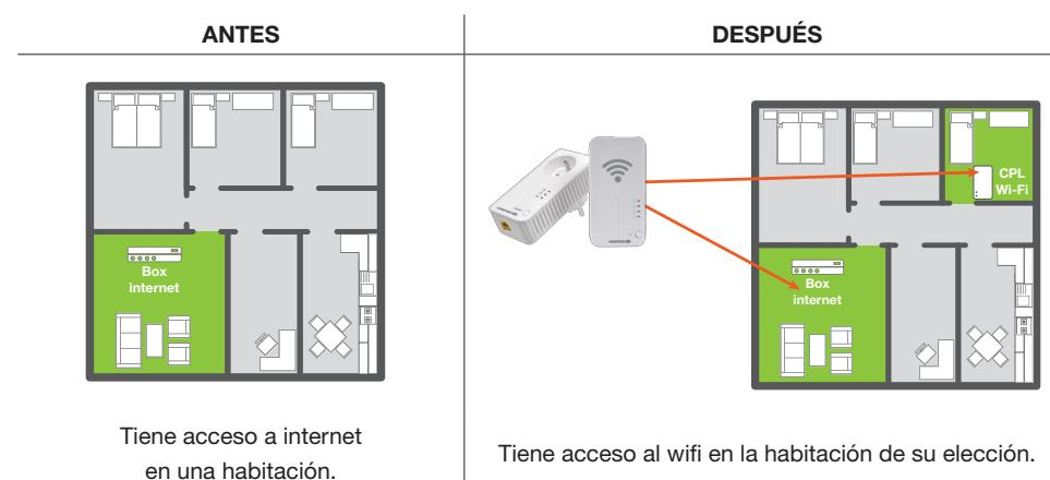
ATENCIÓN: si dispone del adaptador PLC wifi Solo, este no permite crear una red. Son necesarios **dos adaptadores PLC como mínimo** para crear una red de alta velocidad. **El adaptador PLC wifi Solo le permite únicamente transformar una red existente por cable en una red inalámbrica.**
