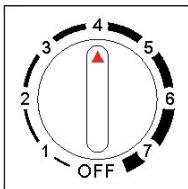
Tournez le bouton du thermostat dans le sens des aiguilles d'une montre : l'appareil se met en route automatiquement.
