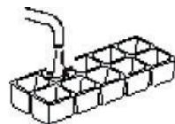
**WICHTIG:** Versuchen Sie niemals, einen festgefrorenen Eiswürfelbehälter mit scharfen oder spitzen Gegenständen aus dem Eisbereiterfach zu lösen, da dies den Kühlkreislauf beschädigen kann. Verwenden Sie einen Kunststoffschaber.
