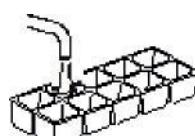
**IMPORTANT :** N'essayez jamais de détacher un bac à glaçons collé par le gel dans le compartiment de fabrication de glace avec des objets pointus ou aiguisés car vous risqueriez d'endommager le circuit de réfrigération. Utilisez un racloir en plastique.
