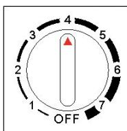
Drehen Sie den Thermostatkopf im Uhrzeigersinn: das Gerät startet automatisch.
