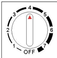
Gire el botón del termostato en el sentido contrario a las agujas del reloj: el aparato se pone en funcionamiento automáticamente.
