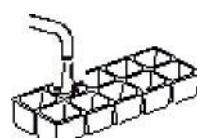
**BELANGRIJK:** Probeer nooit een bak voor ijsblokjes die vastgevroren is in het compartiment om ijs te maken los te maken met scherpe voorwerpen of voorwerpen met een punt aangezien u het koelcircuit zou kunnen beschadigen. Gebruik een schraper in kunststof.
