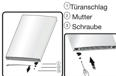
8. Drehen Sie die Schrauben des mittleren Scharniers heraus und entfernen dieses. Nehmen Sie dann die untere Tür ab.
