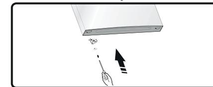
10. Versetzen Sie die Schrauben des mittleren Scharniers (wie auf der untenstehenden Zeichnung gezeigt) von links nach rechts.
