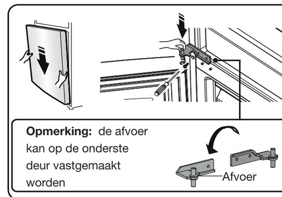
15. Plaats de bovenste deur terug op het middelste scharnier. Steek de elektrische kabel ③ in de opening van het scharnier ② en zet vervolgens het scharnier vast ① met schroeven ①.
