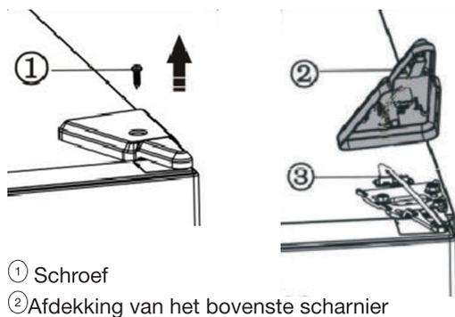
3. Verwijder de schroeven ① en het scharnier ②. Steek de elektrische kabels door de opening van de scharnier ② (houd de bovenste deur vast met uw hand).
