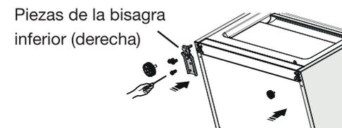
14. Vuelva a colocar la puerta inferior en el eje inferior de la bisagra y manténgala en su posición. Gire la bisagra central 180°, desenrosque y vuelva a colocar la arandela debajo del eje. Ajuste la bisagra a la posición correcta y asegúrela, y compruebe que la puerta inferior esté asegurada.
