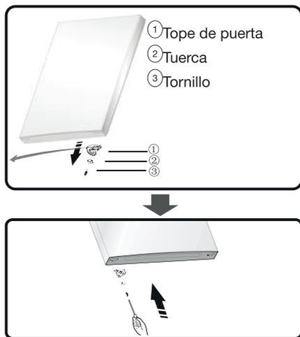
10. Mueva los capuchones de las tapas de los tornillos de la bisagra intermedia de izquierda a derecha (como se muestra en el diagrama de abajo).
