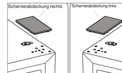
6. Ziehen Sie die (linke) Abdeckung ① oben links an der Tür ab und ziehen das Stromkabel heraus ②. Ziehen Sie dann die (rechte) Abdeckung ③ ab und stecken das Kabel ④ oben rechts in die Tür. Nehmen Sie auf die oben dargestellten Vorgänge Bezug. Bringen Sie das Teil ③ und das Teil ④ oben links an der Tür an. Bringen Sie das Teil ① oben links an der Tür an.
