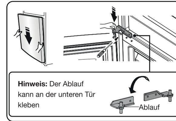
15. Setzen Sie die obere Tür wieder auf das mittlere Scharnier. Führen Sie das Stromkabel ③ durch die Öffnung im Scharnier ② und befestigen dann das Scharnier ② mit den Schrauben ①.
