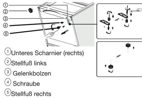
12. Schrauben Sie sämtliche Teile des unteren rechten Scharniers ab und entfernen diese.
