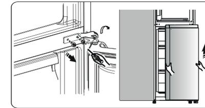
9. Leg de deur verticaal op een zachte ondergrond. Draai de schroeven los ③ en verwijder de onderdelen ② en ①. Installeer de meegeleverde aanslag van de linkerdeur ④ (in het zakje met accessoires) en onderdeel ② (moer) op de linkerkant met de schroef ③. Berg het onderdeel op ① in het zakje met accessoires.
