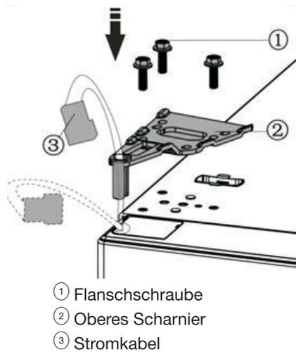
16. Schließen Sie das Stromkabel ① wie untenstehend gezeigt an und befestigen dann die Abdeckung des oberen Scharniers ② mit der Schraube ③. Nehmen Sie auf Schritt 2 Bezug.
