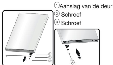
8. Draai de schroeven van het middelste scharnier en verwijder het scharnier. Verwijder vervolgens de onderste deur.
