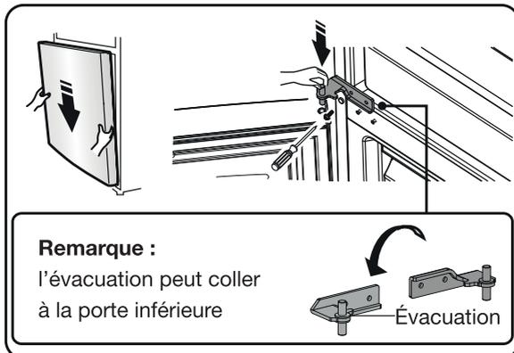
15. Remplacez la porte supérieure sur la charnière du milieu. Faites passer le fil électrique ③ dans l'ouverture de la charnière ② puis, fixez la charnière ② avec les vis ①.
