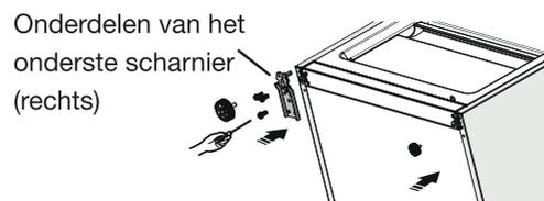
14. Plaats de onderste deur terug op de as van het onderste scharnier en houd vast. Draai het middelste scharnier naar 180°, schroef los en breng de sluitring aan onder de as. Zet het scharnier op de juiste positie, zet vast en controleer of de onderste deur vast zit.
