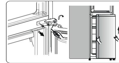
9. Stellen Sie die Tür aufrecht auf eine weiche Fläche. Lösen Sie die Schraube ③ und ziehen die Teile ② und ① ab. Bringen Sie den linken Türanschlag ④, der (im Zubehörbeutel) mitgeliefert wurde und das Teil ② (Mutter) links neben der Schraube ③ an. Verstauen Sie das Teil ① im Zubehörbeutel.
