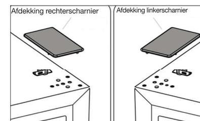
6. Verwijder de (linker) afdekking ① links bovenaan de deur en haal de elektrische kabel er uit ②. Gelieve vervolgens de (rechter) afdekking ③ en breng de elektrische kabel ④ naar de rechter bovenkant van de deur. Raadpleeg de hierboven uitgelegde handelingen. Installeer onderdeel ③ en onderdeel ④ links bovenaan de deur. Installeer het onderdeel ① bovenaan de deur.
