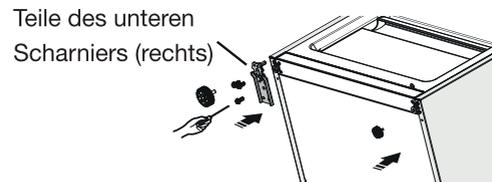
14. Setzen Sie die untere Tür wieder auf den Bolzen des unteren Scharniers und halten sie fest. Drehen Sie das mittlere Scharnier um 180°, schrauben es los und legen die Unterlegscheibe unter den Bolzen. Justieren Sie das Scharnier in der richtigen Stellung ein und befestigen es, wobei Sie darauf achten, dass die untere Tür gesichert ist.
