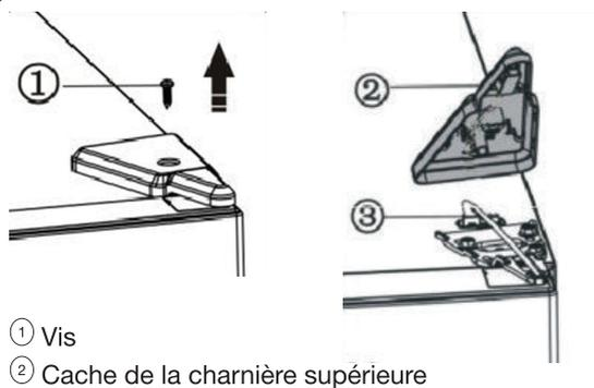
3. Retirez les vis ① et la charnière ②. Faites passer les fils électriques dans l'ouverture de la charnière ② (maintenez la porte supérieure avec votre main).
