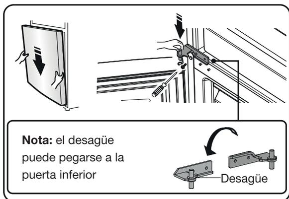
15. Vuelva a colocar la puerta superior en la bisagra del medio. Pase el cable eléctrico ③ a través de la abertura de la bisagra ② y, a continuación, asegure la bisagra ② con los tornillos ①.
