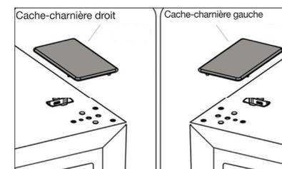
6. Retirez le cache (gauche) ① en haut à gauche de la porte et sortez le fil électrique ②. Puis, retirez le cache (droit) ③ et rentrez le fil électrique ④ en haut à droite de la porte. Référez-vous aux opérations présentées plus haut. Installez la pièce ③ et la pièce ④ en haut à gauche de la porte. Installez la pièce ① en haut à gauche de la porte.
