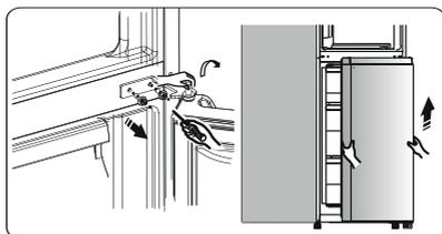
9. Coloque la puerta en una superficie suave, en vertical. Afloje el tornillo (3) y quite las piezas (2) y (1). Instale el tope de la puerta izquierda (4) incluido (en la bolsa de accesorios) y la pieza (2) (tuerca) en el lado izquierdo con el tornillo (3). Guarde la pieza (1) en la bolsa de accesorios.
