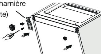
14. Remplacez la porte inférieure sur l'axe de la charnière inférieure et maintenez-la en position. Tournez la charnière du milieu à 180°, dévissez et replacez la rondelle sous l'axe. Ajustez la charnière à la bonne position et fixez-la, tout en vérifiant que la porte inférieure est sécurisée.
