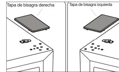
6. Retire la tapa (izquierda) ① en la parte superior izquierda de la puerta y saque el cable eléctrico ②. A continuación, quite la tapa (derecha) ③ y meta el cable eléctrico ④ en la parte superior derecha de la puerta. Consulte las operaciones presentadas anteriormente. Instale la pieza ③ y la pieza ④ en la parte superior izquierda de la puerta. Instale la pieza ① en la parte superior izquierda de la puerta.
