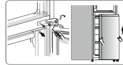
9. Placez la porte sur une surface douce, à la verticale. Desserrez la vis ③ et retirez les pièces ② et ①. Installez la butée de porte gauche ④ fournie (dans le sachet des accessoires) et la pièce ② (écrou) sur le côté gauche avec la vis ③. Rangez la pièce ① dans le sachet des accessoires.
