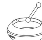
4. Gebruik een wattenstaafje om de keramische schijf te reinigen en een zachte doek om het reservoir droog te wrijven.
