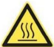
Bitte berühren Sie während des Gebrauchs nicht die Oberfläche. Die Temperatur der zugänglichen Oberflächen kann sehr hoch sein, wenn das Gerät in Betrieb ist.
