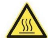
Ne touchez pas les surfaces de l'appareil pendant l'utilisation. La température des surfaces accessibles peut être élevée quand l'appareil est en fonctionnement.
