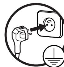
Der Mikrowellenofen ist mit einem geerdeten Stecker ausgestattet. Das Gerät muss mit einer vorschriftsmäßig installierten und geerdeten Wandsteckdose verbunden werden.
