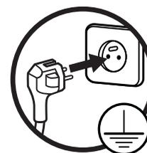
Este microondas está equipado con un enchufe con toma a tierra. Debe conectarse a un enchufe de pared correctamente instalado y con toma a tierra.
