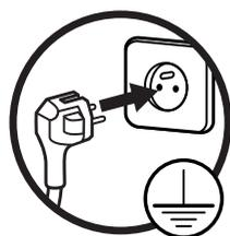
Ce four à micro-ondes est équipé d'une prise électrique de terre. Il doit être branché sur une prise murale correctement installée et équipée d'une prise de terre.
