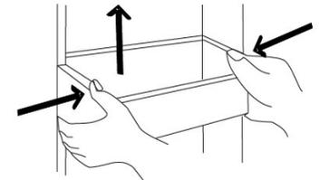
3. Les clayettes étant équipées d'une butée à l'arrière pour les stabiliser sur l'appareil, soulevez-les légèrement puis tirez-les vers l'avant, comme indiqué sur la figure ci-dessous, pour les sortir avant de les nettoyer.
