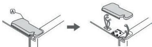
2. Draai de schroef van de scharnier B tegen de wijzers van de klok in los en verwijder de scharnier vervolgens. Laat de deur niet vallen.
