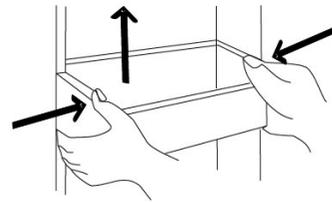
3. Die Ablagen sind an der Rückseite mit einer Halteleiste versehen, die sie vor Verrutschen schützt. Um sie für die Reinigung aus dem Gerät zu nehmen, heben Sie sie daher wie in nebenstehender Abbildung gezeigt leicht an, bevor Sie sie nach vorne herausziehen.
