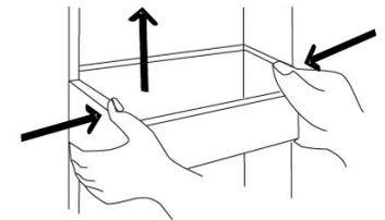
3. Las baldas están equipadas con un tope en la parte posterior para que tengan estabilidad. Cuando vaya a limpiarlas, deberá sacarlas antes. Para ello, levántelas ligeramente y después tire hacia adelante, tal como se muestra en la figura siguiente, .
