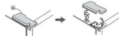
2. Lösen Sie die Schraube des Scharniers B gegen den Uhrzeigersinn und entfernen Sie das Scharnier. Achten Sie darauf, dass die Tür dabei nicht herunterfällt.
