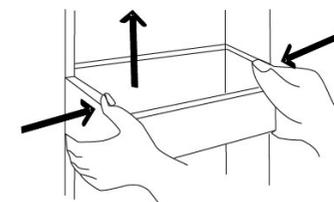
3. De glasplaten hebben een aanslag aan de achterzijde om ze op het apparaat te stabiliseren. Til ze enigszins op en trek ze naar voren, zoals in de onderstaande afbeelding, om ze te verwijderen alvorens ze te reinigen.
