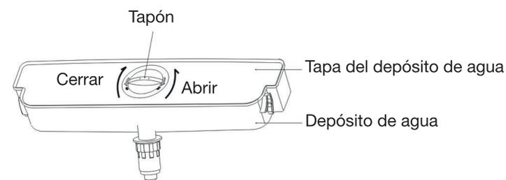
3. Cuando lo llene por completo, ajuste la temperatura del compartimento de refrigeración al ajuste más frío (2 °C) y espere al menos 30 minutos. Después podrá servirse un vaso de agua fresca. Para ello, presione el vaso (u otro recipiente) contra la lengüeta tal como se muestra en la figura anterior.
