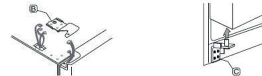
3. Heben Sie die Tür senkrecht an und entfernen Sie das untere Scharnier C.
