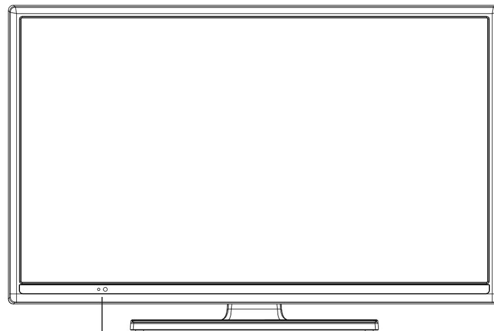
Capteur de la télécommande : Reçoit les signaux émis par la télécommande.
