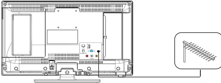
Afin d'obtenir la meilleure qualité d'image par voie hertzienne, il est fortement recommandé d'utiliser une antenne extérieure. Raccordez l'antenne à la prise d'entrée de l'antenne située sur le côté droit du téléviseur. La qualité de l'image varie en fonction de la qualité de votre réception.
