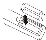
La télécommande fonctionne avec 2 piles de type LR03 AAA 1,5 V. Nous vous recommandons de n'utiliser que des piles alcalines. Retirez les piles de la télécommande si vous prévoyez de ne pas l'utiliser pendant un certain temps (plus d'un mois). Les piles usagées doivent être mises au rebut de façon sûre. Déposez-les dans des bacs de collecte prévus afin de protéger l'environnement.
