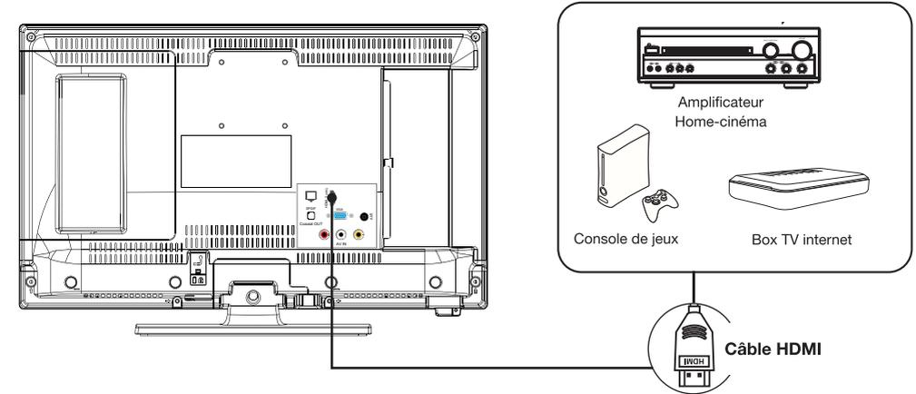
La connexion HDMI achemine des signaux exclusivement numériques. Si votre appareil (Box TV internet, boîtier décodeur...) est équipé d'une prise HDMI, nous vous conseillons d'utiliser ce mode de branchement afin d'obtenir une qualité vidéo optimale.
