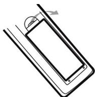
Positionnez les piles dans le boîtier en respectant les indications de polarité « + » et « - » indiquées.
