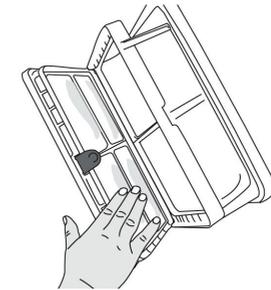
5. Lavez le filtre en mousse à l'eau. Essorez-le pour retirer le surplus d'eau et laissez-le sécher complètement avant de le replacer dans le tiroir du filtre.
