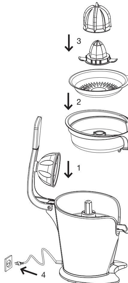
1. Breng het sapreservoir aan op het motorblok en let er daarbij op dat de schenktuit gesloten is of plaats er een houder onder als de schenktuit open staat.
