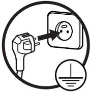
Este microondas está equipado con un enchufe con toma a tierra. En caso de cortocircuito, la toma a tierra reduce el riesgo de descarga eléctrica al permitir que la corriente se descargue a través del cable de tierra.
