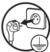
**IMPORTANT** : Débranchez le cordon d'alimentation de la prise de courant avant de procéder au nettoyage et, si possible, laissez la porte ouverte pour désactiver le four.
