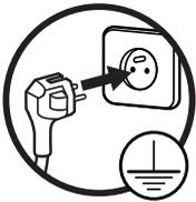
Der Mikrowellenofen ist mit einem geerdeten Stecker ausgestattet. Im Falle eines Kurzschlusses vermindert die Erdung die Gefahr von Stromschlägen und leitet den Strom über den Erdungsleiter ab.
