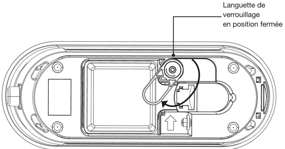
1. Faites pivoter la languette de verrouillage en position ouverte.
