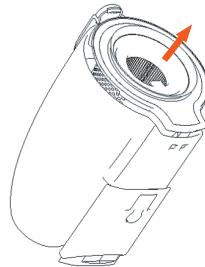
4. Tournez le filtre HEPA dans le sens inverse des aiguilles d'une montre (a), puis retirez-le (b).
