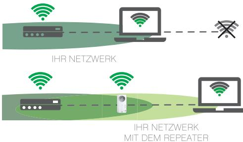
**Wir empfehlen, den Repeater vor Gebrauch zurückzusetzen, indem Sie 6 Sekunden lang die Taste „RE“ gedrückt halten.**
