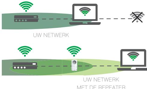
Alvorens uw repeater te gebruiken, raden wij u aan om hem te resetten door 6 seconden op de knop 'RE' te drukken
