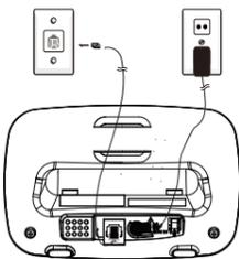
Si vous êtes connecté derrière une box ADSL, un microfiltre est nécessaire (il n'est pas fourni).
