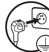
Deze microgolfoven is uitgerust met een geaarde stekker. Bij kortsluiting beperkt de aarding het risico op een elektrische schok doordat de stroom kan worden afgevoerd langs de aardleiding.
