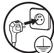
Dieser Mikrowellenofen ist mit einer geerdeten Steckdose ausgestattet. Im Falle eines Kurzschlusses verringert die Erdung das Risiko eines Stromschlags, indem sie eine Ableitung des Stroms durch das Erdungskabel ermöglicht.
