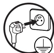
Ce four à micro-ondes est équipé d'une prise électrique de terre. En cas de court-circuit, la mise à la terre réduit le risque de choc électrique en permettant au courant d'être évacué par le fil de terre.
